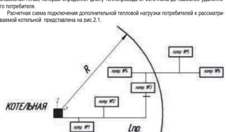
Эти два параметра отражают основное правило построения системы централизованного теплоснабжения - удельная материальная характеристика всегда меньше там, где высокая плотность тепловой нагрузки...
