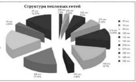
Рисунок 6. Структура тепловых сетей ООО «Пятигорсктеплосервис» по диаметрам трубопровода
